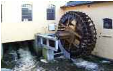
Det vandhjul-drevne hammerværk i den ene af hallerne.
